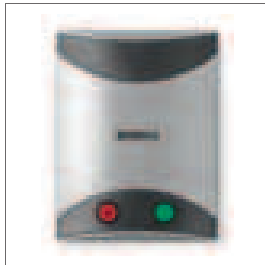
Steuerzentrale 230Vac für 1 oder 2 Motoren mit Flügel- und Schiebetore oder Industrietore. Integriertes Display, zahlreiche Funktionslogiken. Vorbereitung für Funkempfänger zum Ankleben. Möglichkeit der Anzeige der effektiven Manöverzahl. Komplexe Merkmale auf Seite 151
